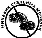
Для защиты поверхностей из нержавеющей стали полностью избегайте применения абразивных чистящих компонентов, чистящих веществ на основе хлора или чистящих веществ с четвертичными солями. **Ни в коем случае** не используйте хлористоводородную (соляную) кислоту для чистки нержавеющей стали. **Никогда** не используйте проволочные щетки, металлические чистящие мочалки или скребки.
