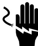
Убедитесь, что напряжение источника питания соответствует напряжению, указанному на паспортной табличке устройства. Паспортная табличка содержит важную техническую информацию, требуемую для установки, обслуживания или ремонта любого устройства. Не снимайте, не портите и не модифицируйте паспортную табличку.
