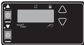
Вариант с полупроводниковой электронной системой управления упрощает настройку температуры. Предусмотрен четкий, легко читаемый ЖК дисплей, и реализуется наша патентованная система восстановления тепла SureTemp™. SureTemp™ немедленно компенсирует любое тепло, теряемое при открывании двери.
