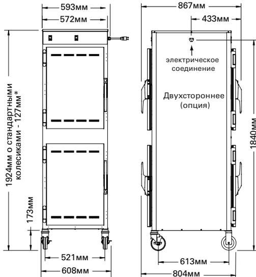
\*1881мм с дополнительными 89-мм роликами
